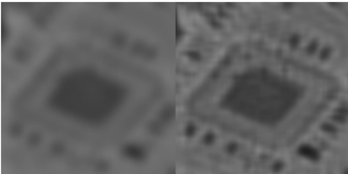
Obrázek 36 - Porovnání Lucy-Richardson dekonvoluce 4096x4096 obrazu na grafické kartě s typem Double [zdroj: autor]
