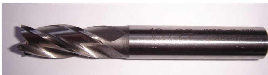
Obr. 3.2 Jeden z nástrojů (HSS Co8) použitý v experimentu od společnosti ZPS-FN, a.s., Zlín
