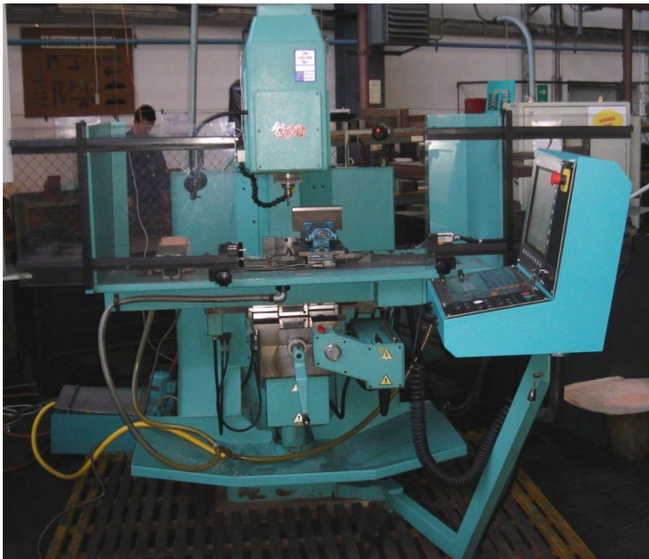
Obr. 3.3 Vertikální konzolová frézka FV 25 CNC
