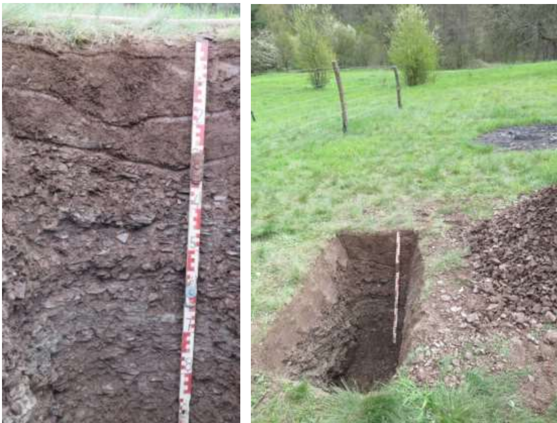
Obr. 3 a 4: Detail půdního profilu s vyznačením jednotlivých horizontů a celkový pohled na umístění sondy na pozemku ZPF (foto Aleš Kučera, duben 2016).
