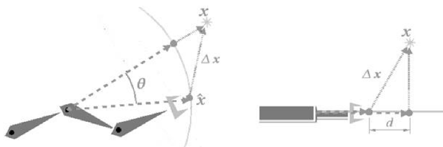
Obrázek 5: Cyclic Coordinate Descent metoda pro a) rotační kloub b) translační kloub [16]
