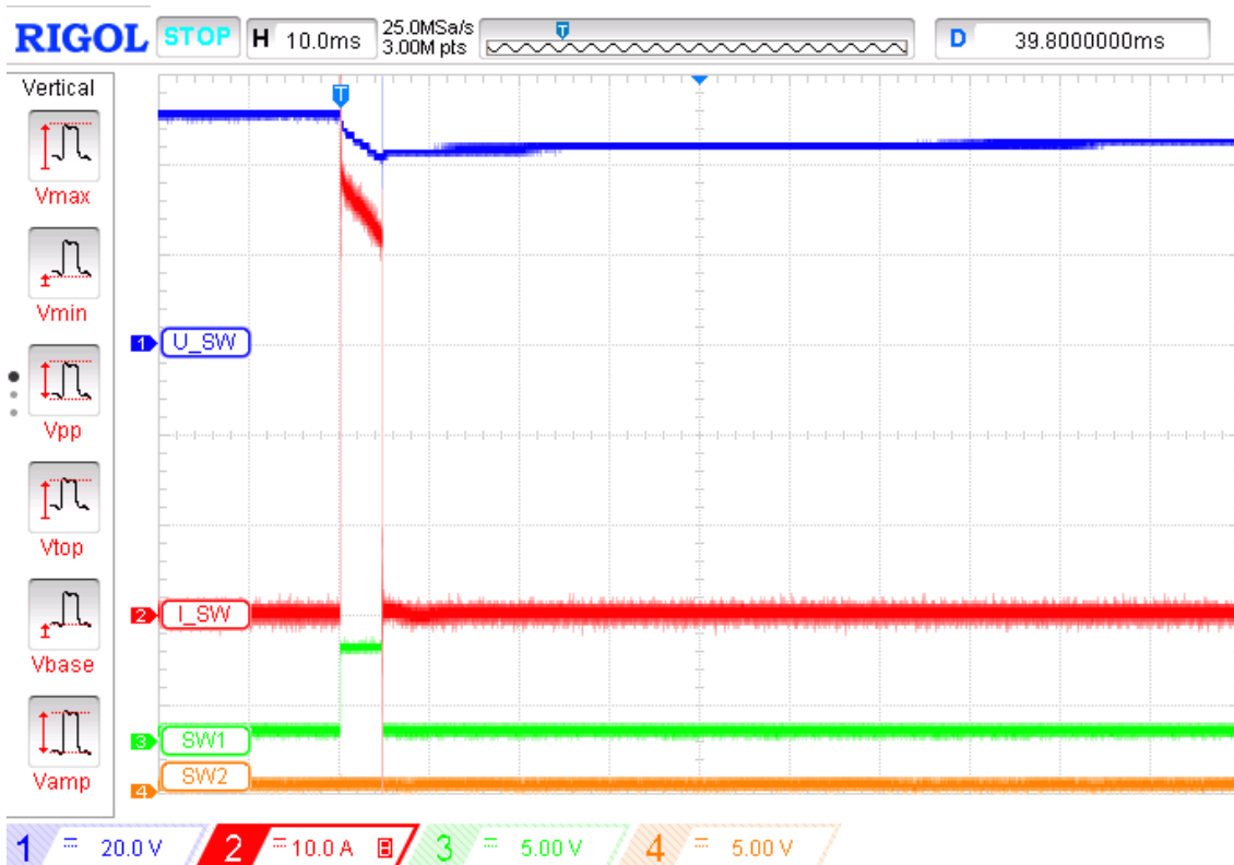
Obrázek č. 10.20: Průběh spínání kapacitní zátěže o velikosti C_L = 26,8 \text{ mF}
