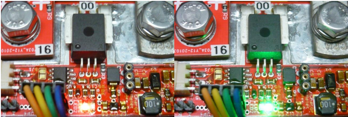
Obrázek č. 9.3: Signalizace nabíjení vlevo, signalizace vybíjení vpravo
