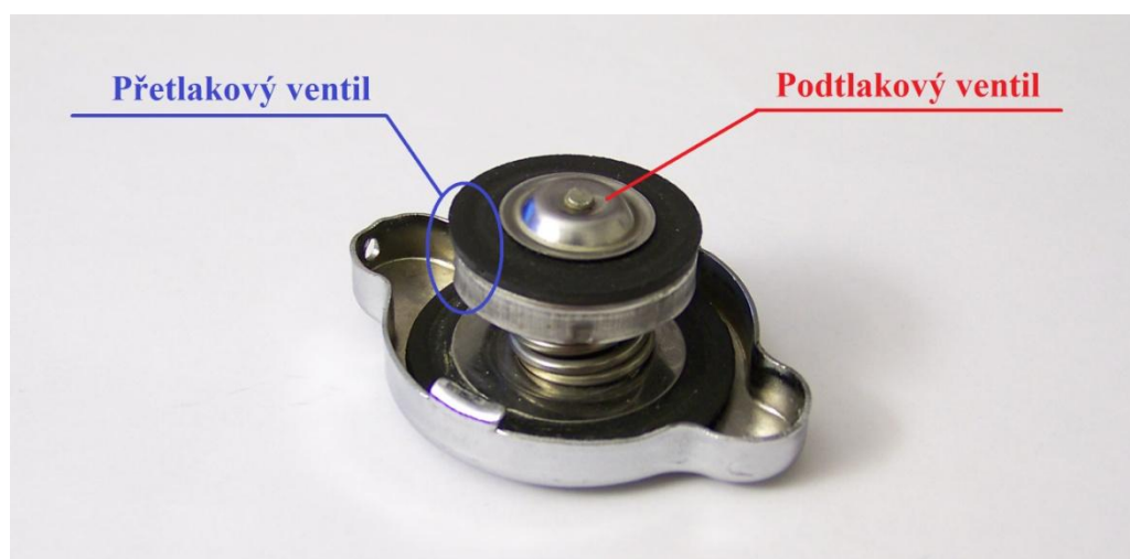
Obr. 35 Víčko s podtlakovým a přetlakovým ventilem
