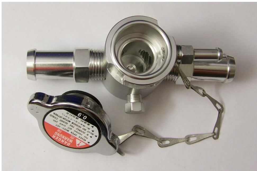
Obr. 23 Dosedací plocha přetlakového ventilu expanzní nádoby
