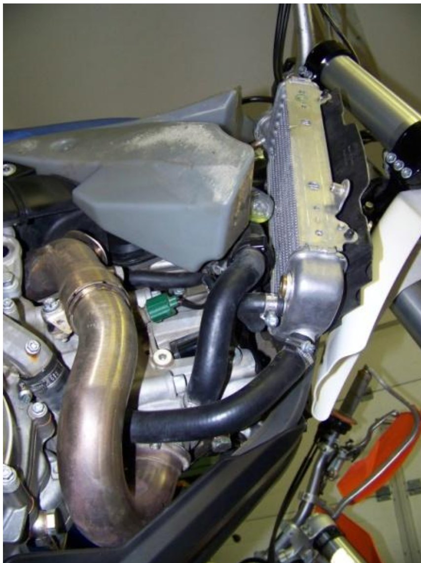
Obr. 15 Chladicí systému motocyklu Husaberg FE 570
