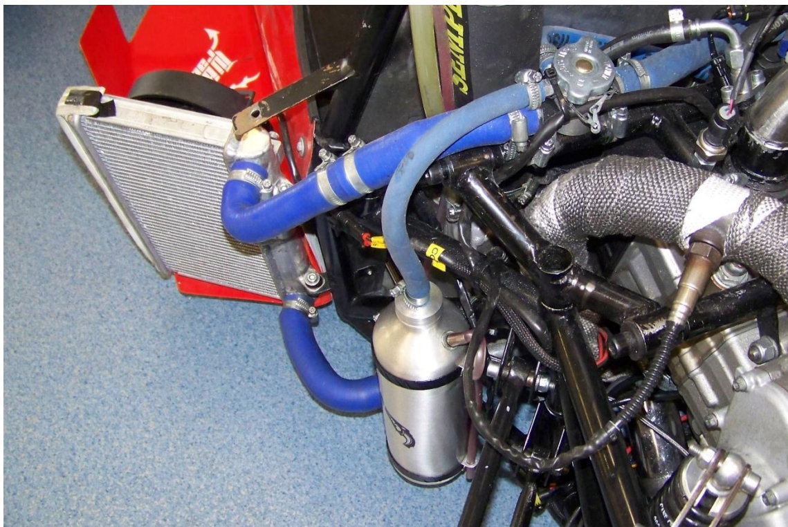
Obr. 27 Reální část chladicí soustavy vozu Dragon 2 se záchytnou nádobou
