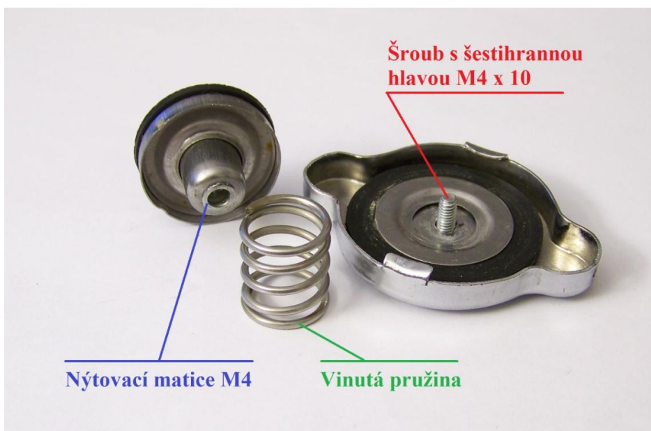
Obr. 36 Konstrukce nastavitelného přetlakového ventilu
