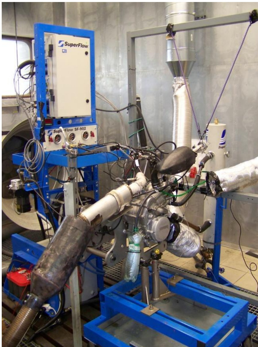
Obr. 11 Kompletní uchycení motoru Husaberg na motorový dynamometr
