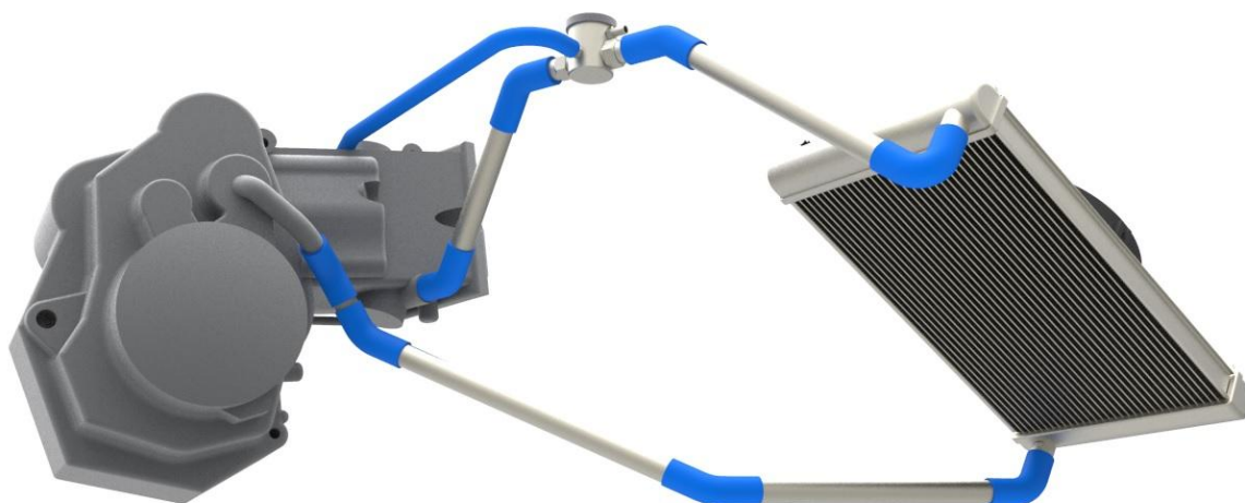
Obr. 37 Potrubí vozu Dragon 3 s chladičem a ventilátorem
