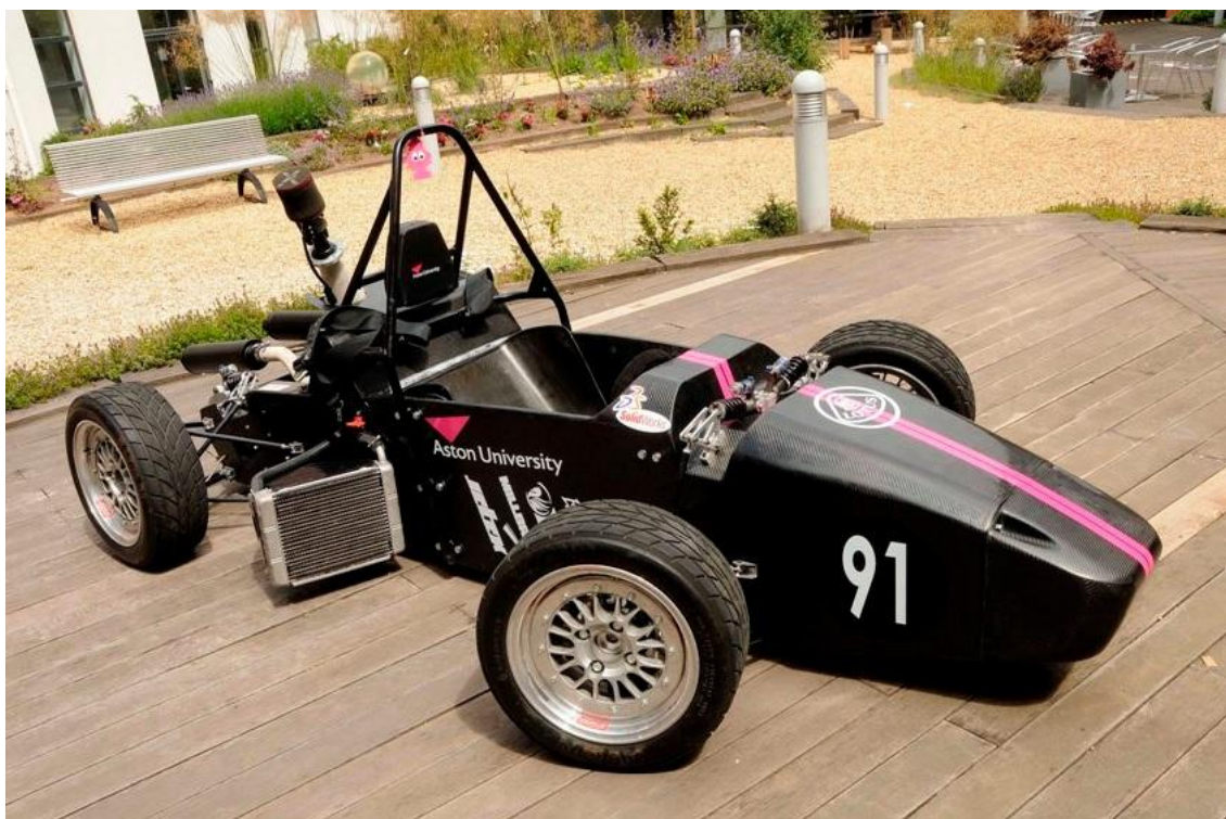
Obr. 5 Chladič na pravé straně vozu týmu Aston University [9]
