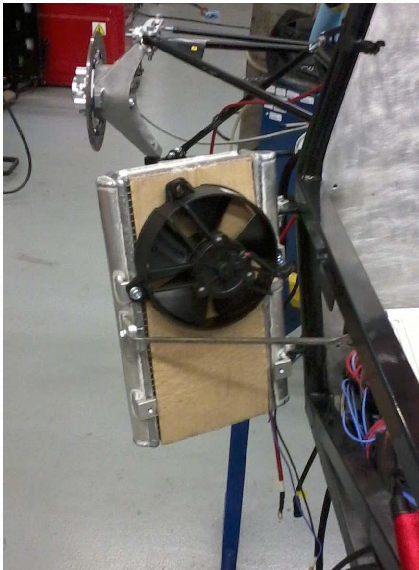
Obr. 20 Uchycení jednoho z chladičů k rámu vozu Dragon 2
