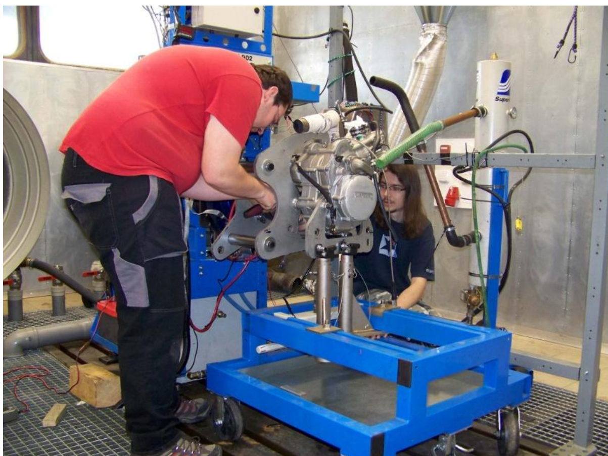
Obr. 9 Připevnění motoru se základovou deskou k dynamometru
