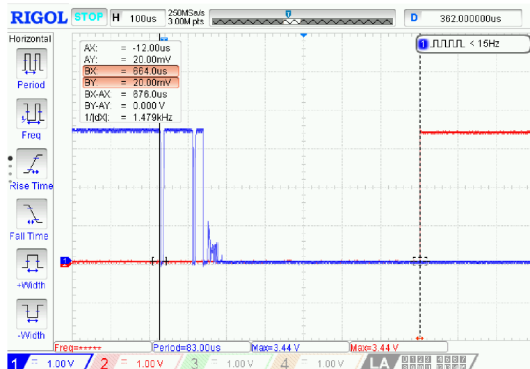
Obr. 37: Průběhy zobrazující dobu vyhodnocení stisku spínače na klávesnici s použitím integrovaných obvodů MC14490.
