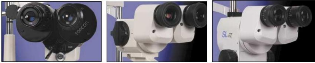
Obrázek 3: Zvětšovací systémy: Greenoughův systém (vlevo), Galileův rotační systém (uprostřed) a Zoomovací systém (vpravo) [6]
