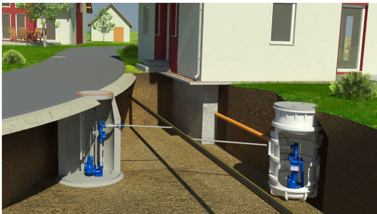
Obr.5-Ukázka tlakového systému – LKT-VARIO (Německo) [24]
