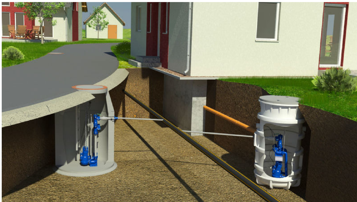
Obr.5-Ukázka tlakového systému – LKT-VARIO (Německo) [24]
