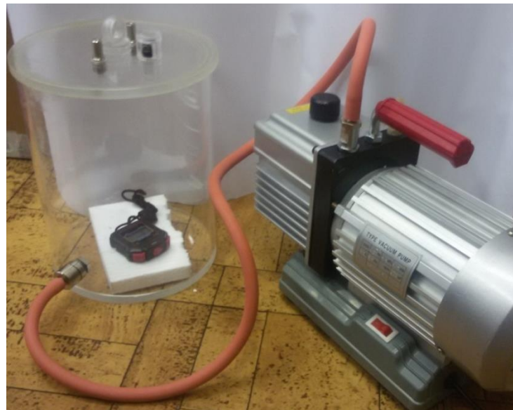
Obrázek 6 - Pokus se stopkami ve vakuu
