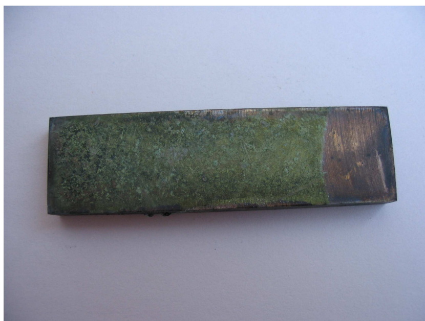
Obr.20 Vzorek 7 (NH 3 , 150 W) po plazmochemickém ošetření
