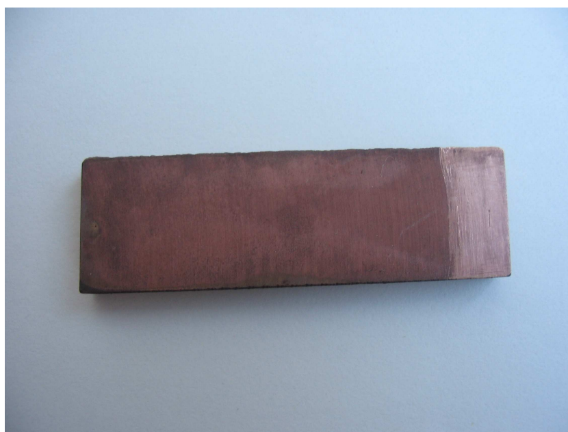
Obr.19 Vzorek 3 (HCl, 150 W) po plazmochemickém ošetření
