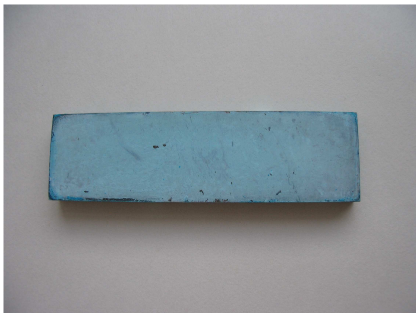
Obr.18 Vzorek mosazi po korodování v amoniaku
