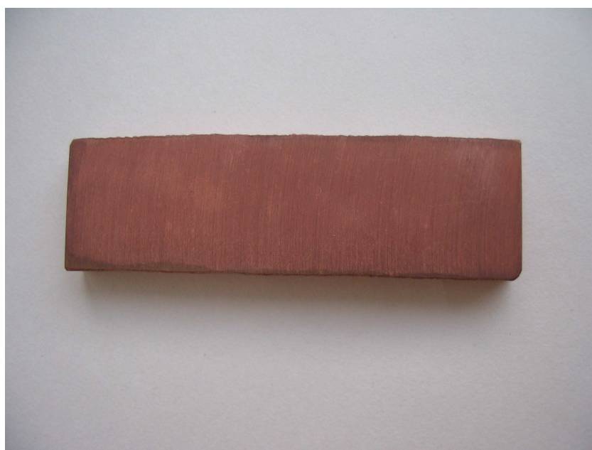
Obr.17 Vzorek mosazi po korodování v parách kyseliny chlorovodíkové
