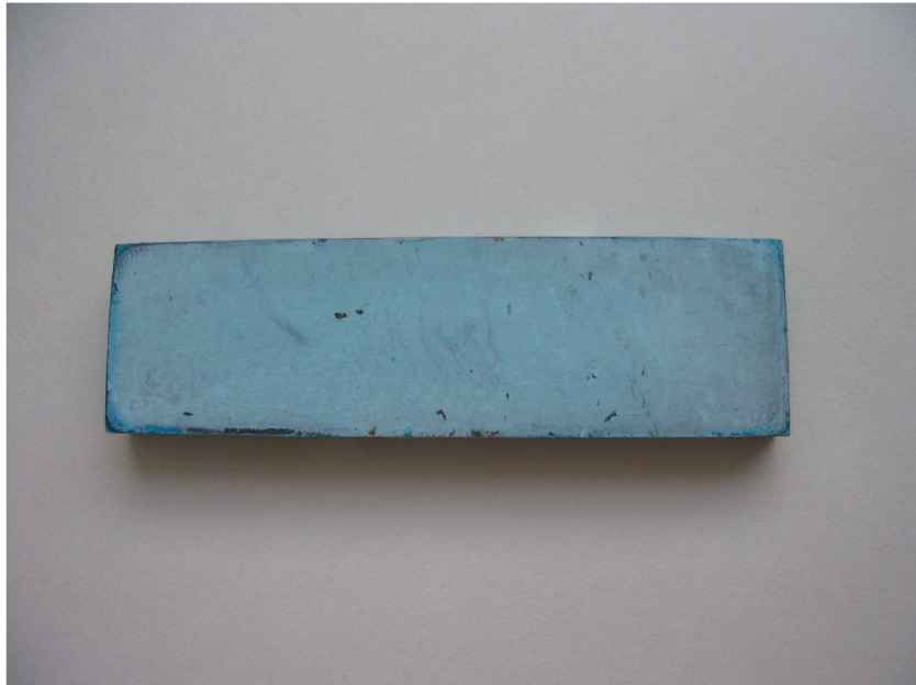
Obr.18 Vzorek mosazi po korodování v amoniaku
