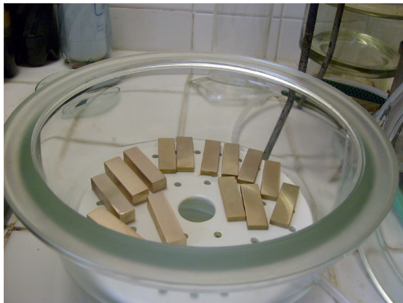
Obr.15 Vzorke mosazi při korodování v parách kyseliny chlorovodíkové společně se vzorky bronzu
