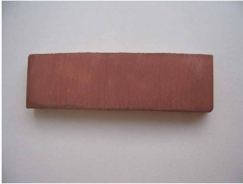
Obr.17 Vzorek mosazi po korodování v parách kyseliny chlorovodíkové
