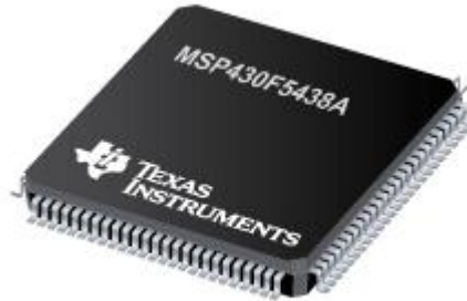
Obrázek 4 - Pohled na mikrokontrolér MSP430F5438A
