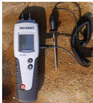
Obrázek 11. Vlhkoměr VOLTCRAFT FM – 300 - Michálek (2013)
