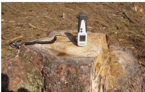
Obrázek 8. Měření vlhkosti u jádra - Michálek (2013)
