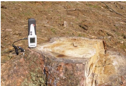
Obrázek 10. Měření vlhkosti běl - Michálek (2013)
