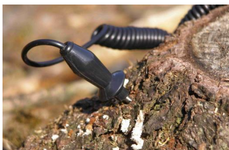
Obrázek 7. Aplikovaná teplotní sonda - Michálek (2013)
