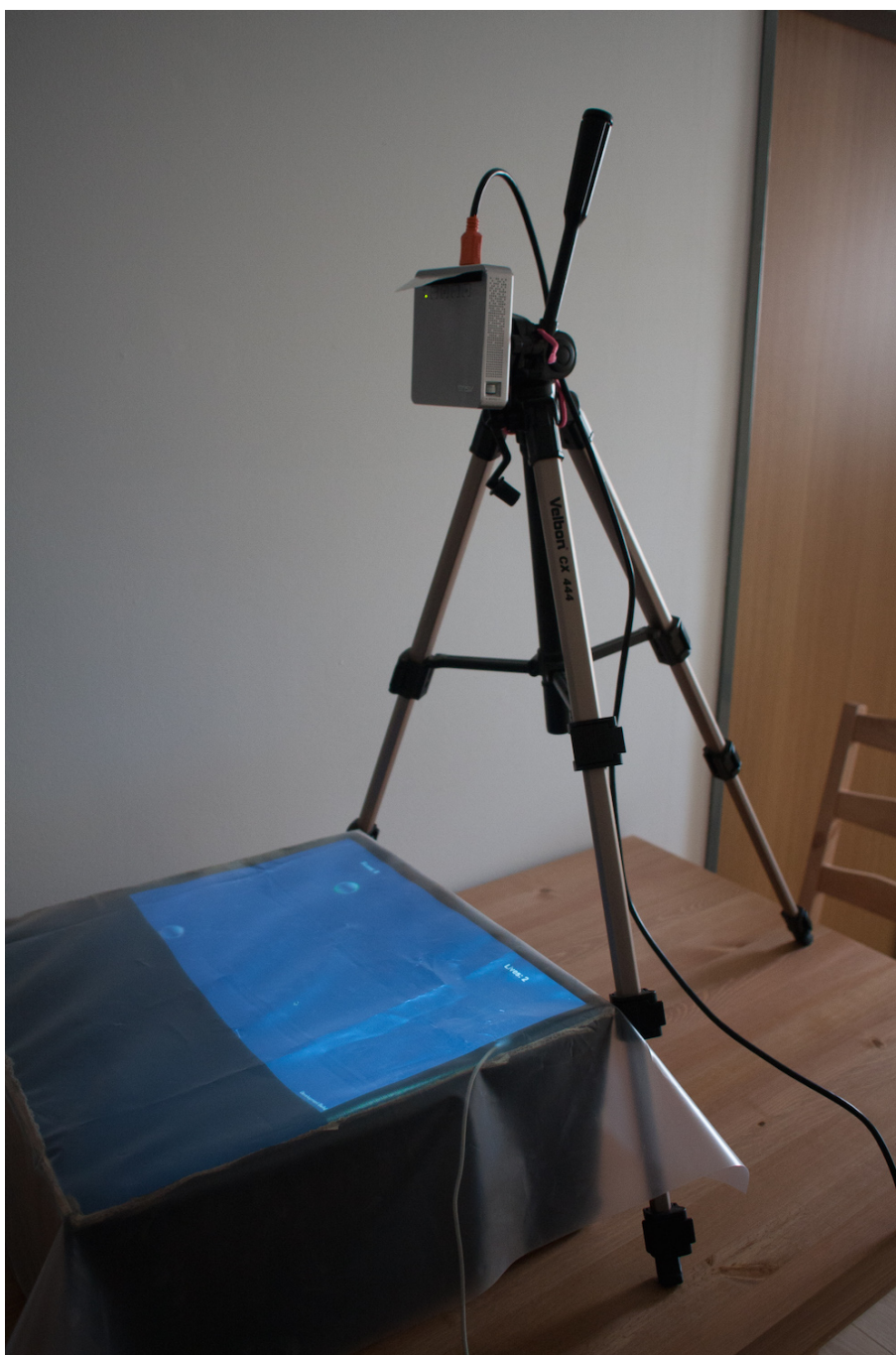
Obrázek 3.8: finální podoba instalace dataprojektoru a Leap Motion s promítáním na fólii
