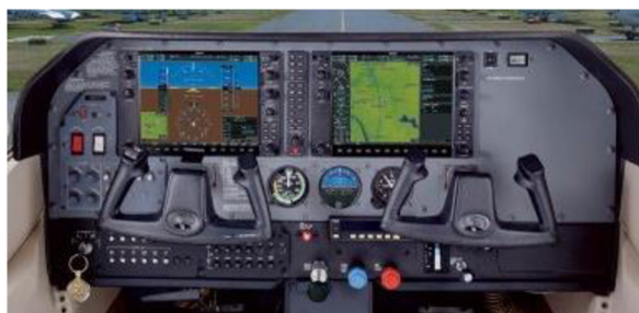
Obr. 2.2: Modernizovaná palubní deska s G1000 [1]
