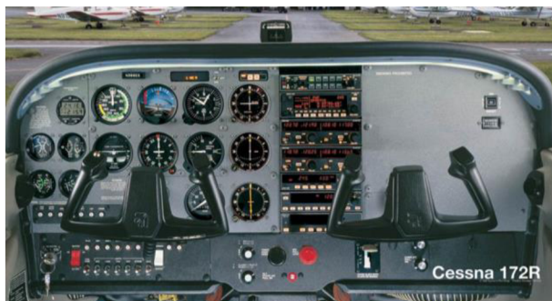
Obr. 2.1: Palubní deska s klasickými mechanickými přístroji [1]
