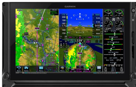
Obr. 3.2: GDU 1060, zobrazení PFD/MFD/EIS [20]
