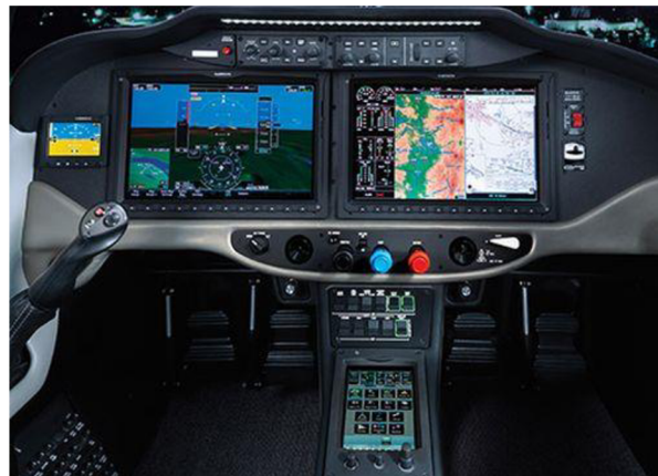
Obr. 2.5: Zástavba systému G2000 [15]
