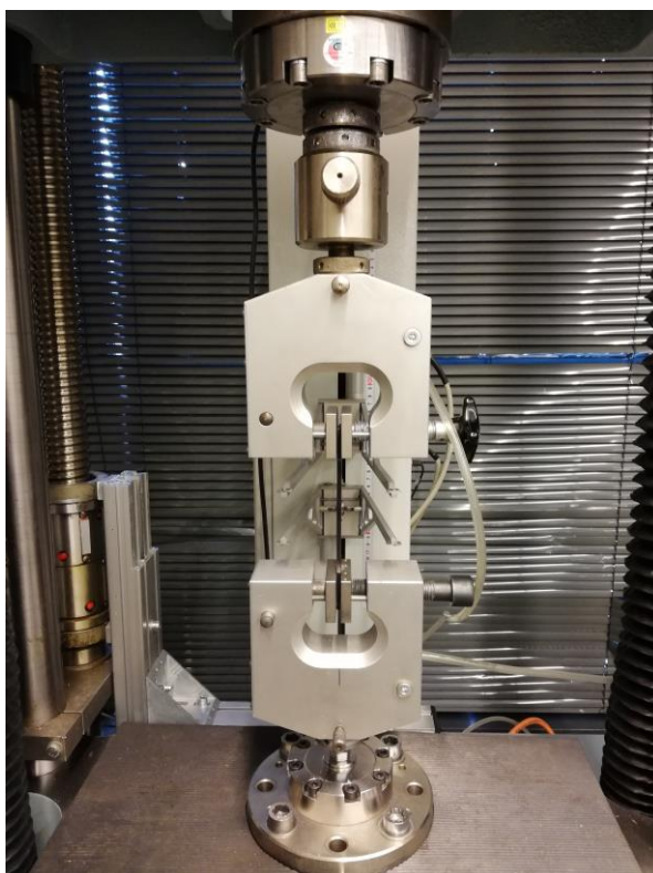
Obr. 3.3 Měření tahových vlastností
