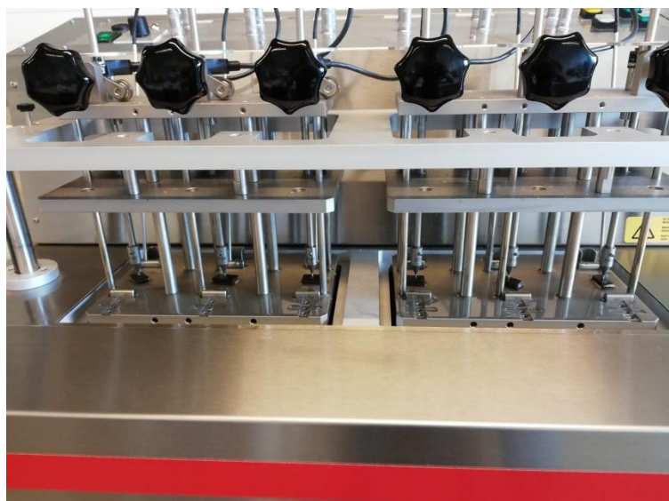
Obr. 3.4 Umístění vzorků pro měření teploty měknutí
