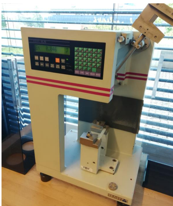
Obr. 3.3 Měření vrubové houževnatosti metodou Charpy
