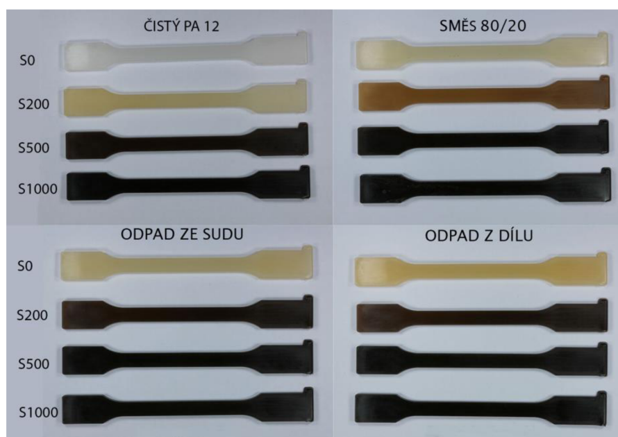
Obr 4.1 Změna zbarvení PA12 vlivem odpadu a umělého stárnutí
