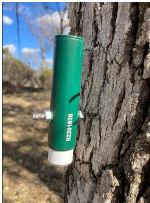
Obrázek 7 Ukázka nainstalovaného bodového dendrometru
