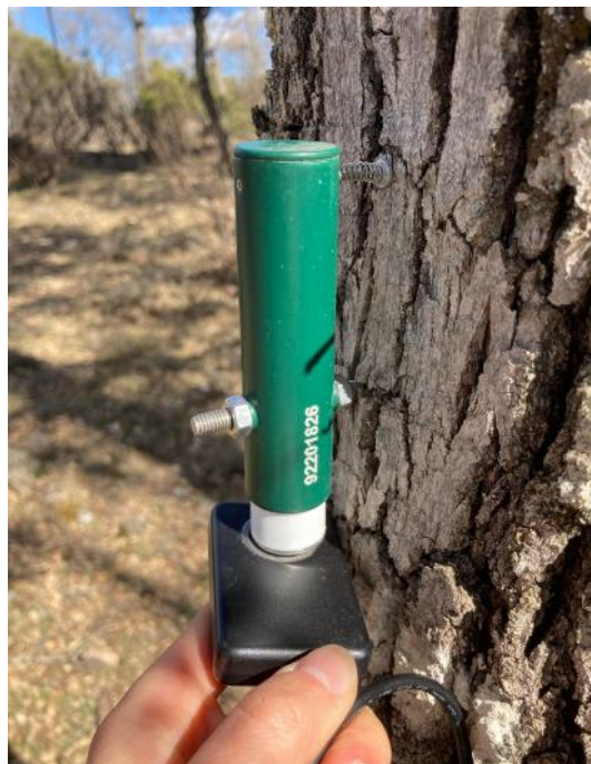
Obrázek 8 Stahování dat pomocí TMD adaptéru
