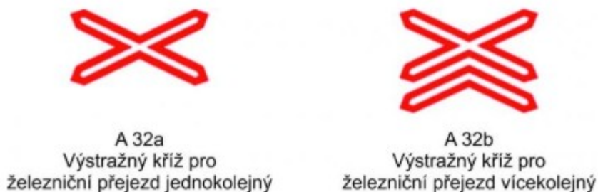
Obr. 3.7 Výstražný kříž (Zdroj: [19])
