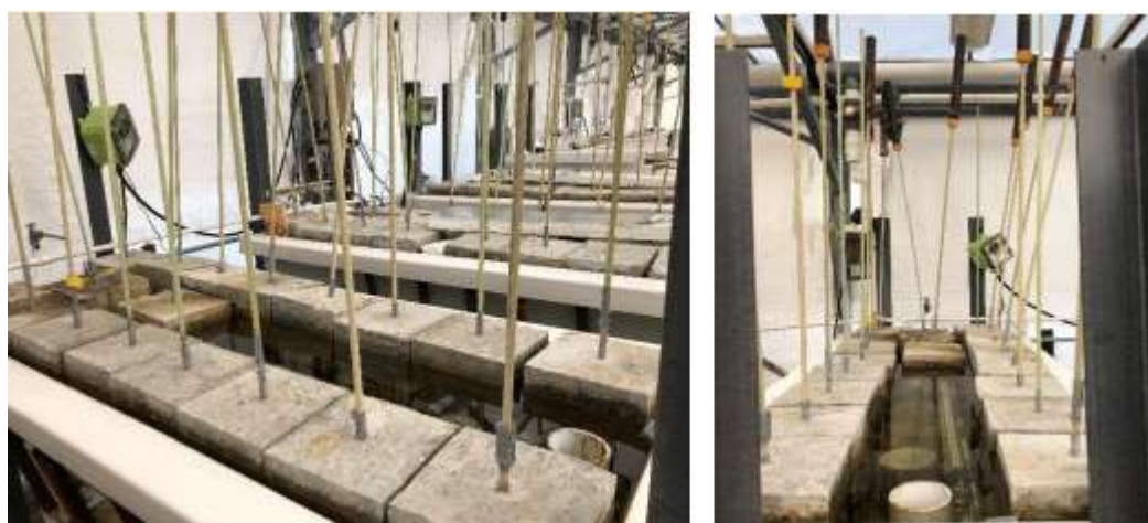
Obrázek 8 Vystavení GFRP výztuží mořské vodě [79]
