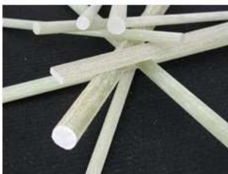
Obrázek 3 Profil se skleněnými vlákny [6]
