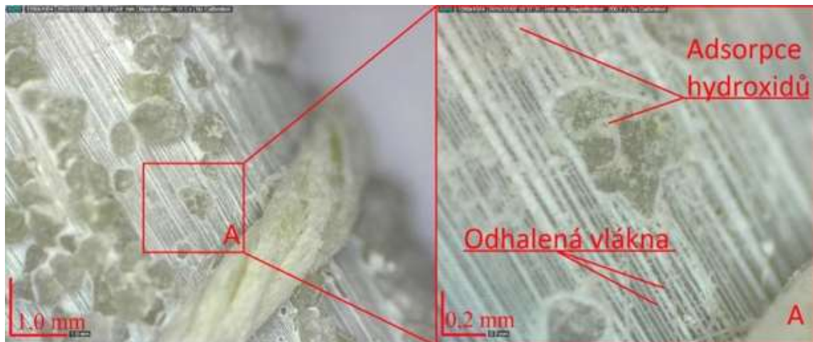
Obrázek 11 GFRP výztuž uložená v alkalickém roztoku; 20 °C (vlevo zvětšeno 50x; vpravo 200x) [34]
