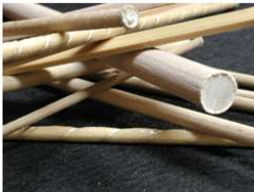
Obrázek 6 Profil s aramidovými vlákny [6]
