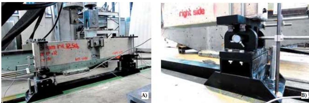
Obrázek 29 Reálná nosníková zkouška: a) uspořádání, b) posuvná podpora [74]
