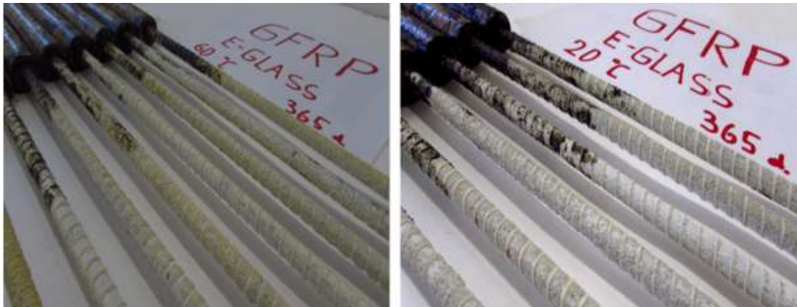
Obrázek 9 Vzorky po 365 dnech expozice; vlevo 60 °C, vpravo 20 °C [34]
