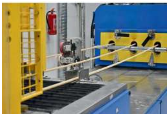
Obrázek 1 Snímek pultruzní linky pro výrobu FRP výztuže [5] [10]
