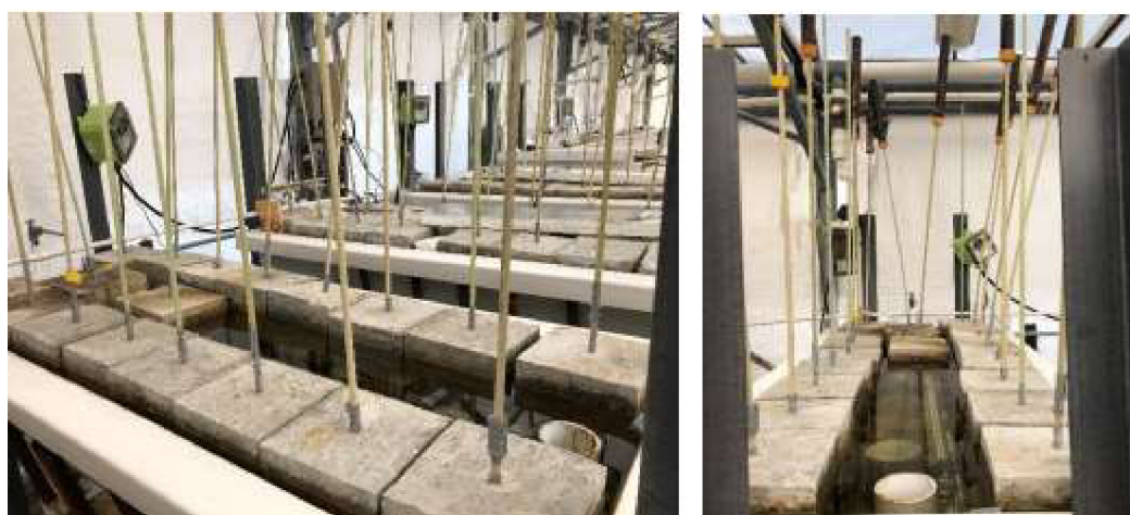
Obrázek 8 Vystavení GFRP výztuží mořské vodě [79]
