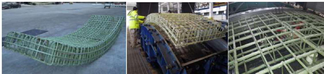
Obrázek 20 GFRP výztuž do prefabrikovaného ostění tunelu [72]
