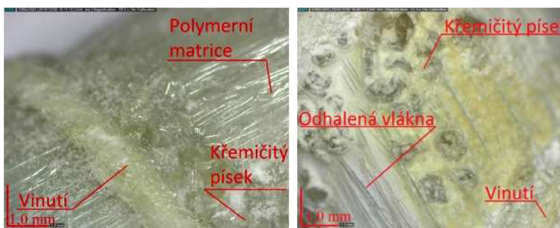
Obrázek 10 Referenční GFRP výztuž uložená v laboratorním prostředí na vzduchu; vpravo GFRP výztuž uložená 365 dní v alkalickém roztoku při teplotě 40 °C [34]
