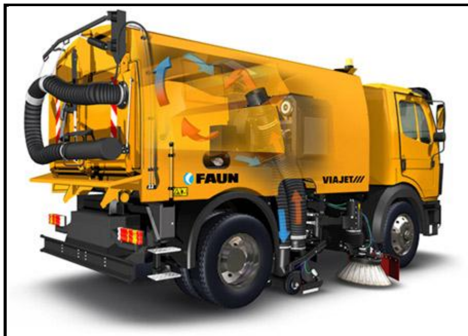
Obrázek 9 - Koncepte zametacího stroje FAUN VIAJET – oběhový systém vzduchu
