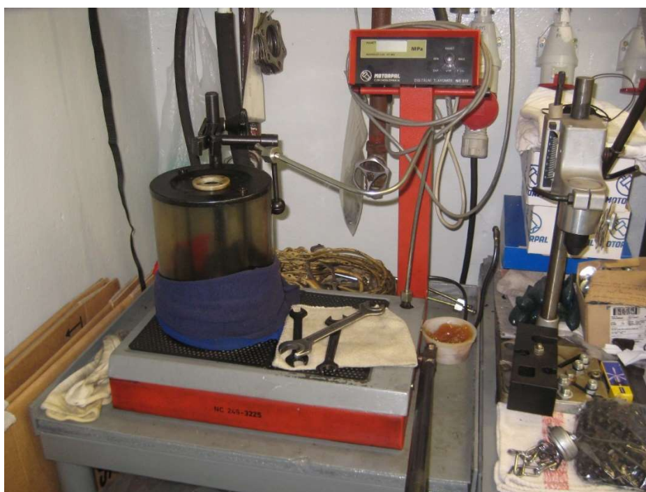
Obrázek č. 38 - Zkušební přístroj Motorpal NC217 před upnutím vstříkovače
