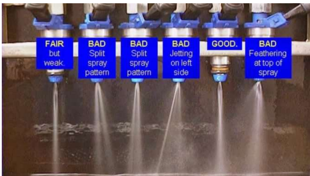
Obrázek č. 19 - Různé způsoby rozprašení paliva,
