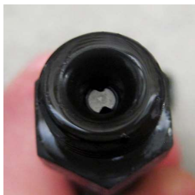
Obrázek č. 21 - Přívodní hrdlo a jeho štěrbinové čističe
