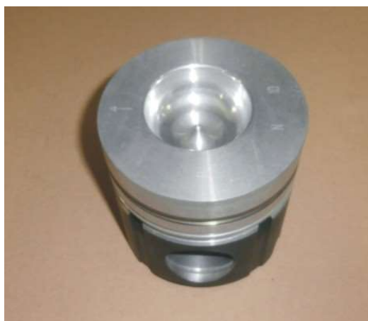
Obrázek č. 1 - Prohloubené dno pístu motoru Tatra T-815,
