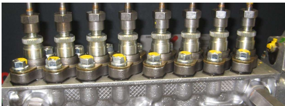
Obrázek č. 12 - Upevnění vložek pomocí šroubů do skříně čerpadla
