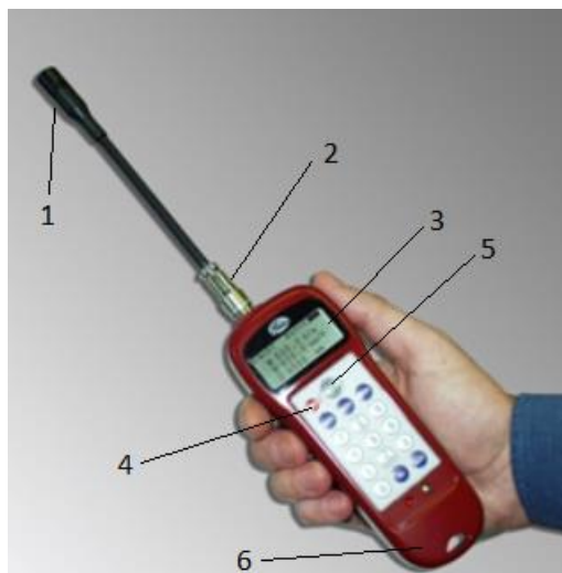
Obrázek 25 – Popis zvukového měřiče Sonic 508C od firmy GATES 1 – pružné čidlo 2 – konektor čidla 3 – displej LCD s podsvícením 4 – vypínač 5 – tlačítko měření 6 – baterie [31]
