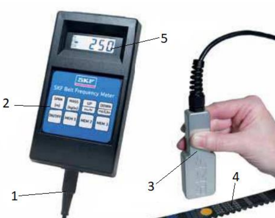
Obrázek 24 – Rychlý start frekvenčního měřiče od firmy SKF 1 – připojení snímače 2 – zapnutí měřiče stisknutím 3 – zaimření snímače na řemen ve vzdálenosti 5 až 25 mm 4 – klepnutí nebo trhnutí řemenem 5 – odečtení frekvence řemenu (Hz) [27]
