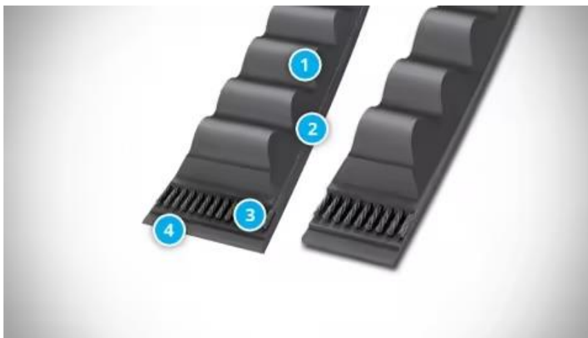
Obrázek 9 – Profil klínových řemenů CONTI-V FO od f. TYMA 1 – Tělo řemenu 2 – Zalévací směs 3 – Tažná vlákna 4 – Krycí tkanina [14]
