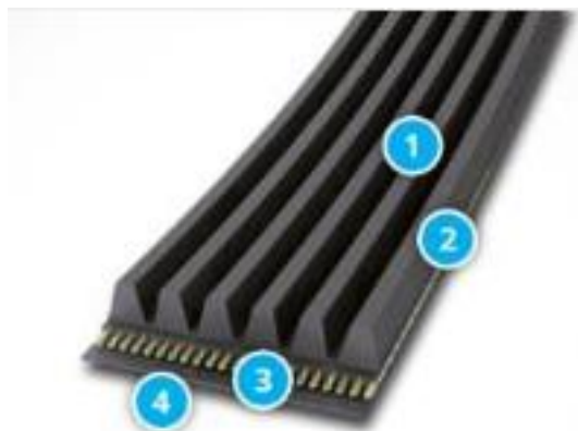
Obrázek 10 – Profil drážkovaných řemenů f. TYMA 1 – Drážky 2 – Zalévací směs 3 – Tažná vlákna 4 – Krycí tkanina [14]
