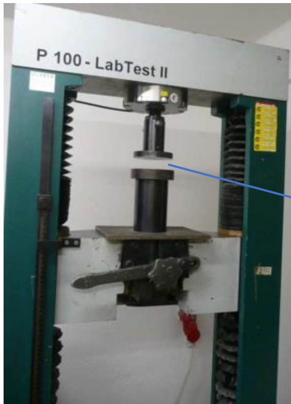
Obr. 15 Univerzální trhací přístroje P100 – Labtest II v tlaku
