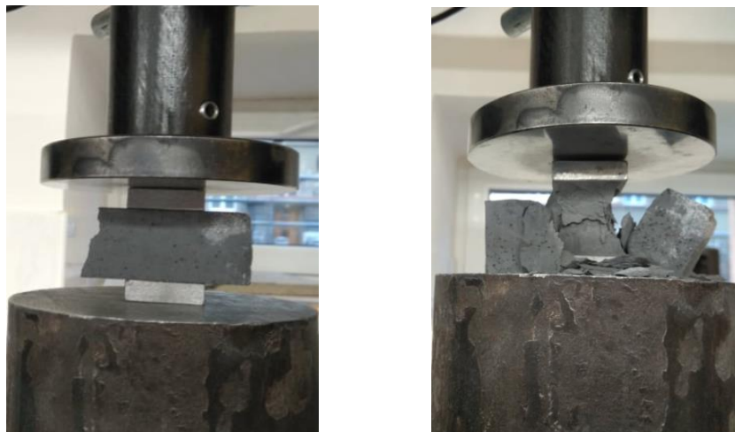
Obr. 31 Vzorek před (vlevo) a po (vpravo) zkoušce v tlaku
