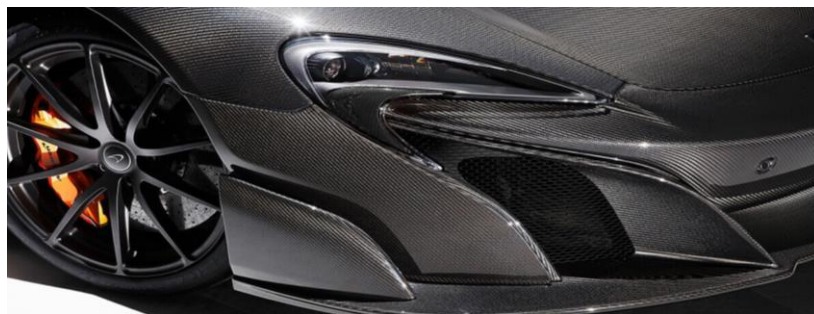
Obr.10 Karoserie auta z uhlíkových vláken
