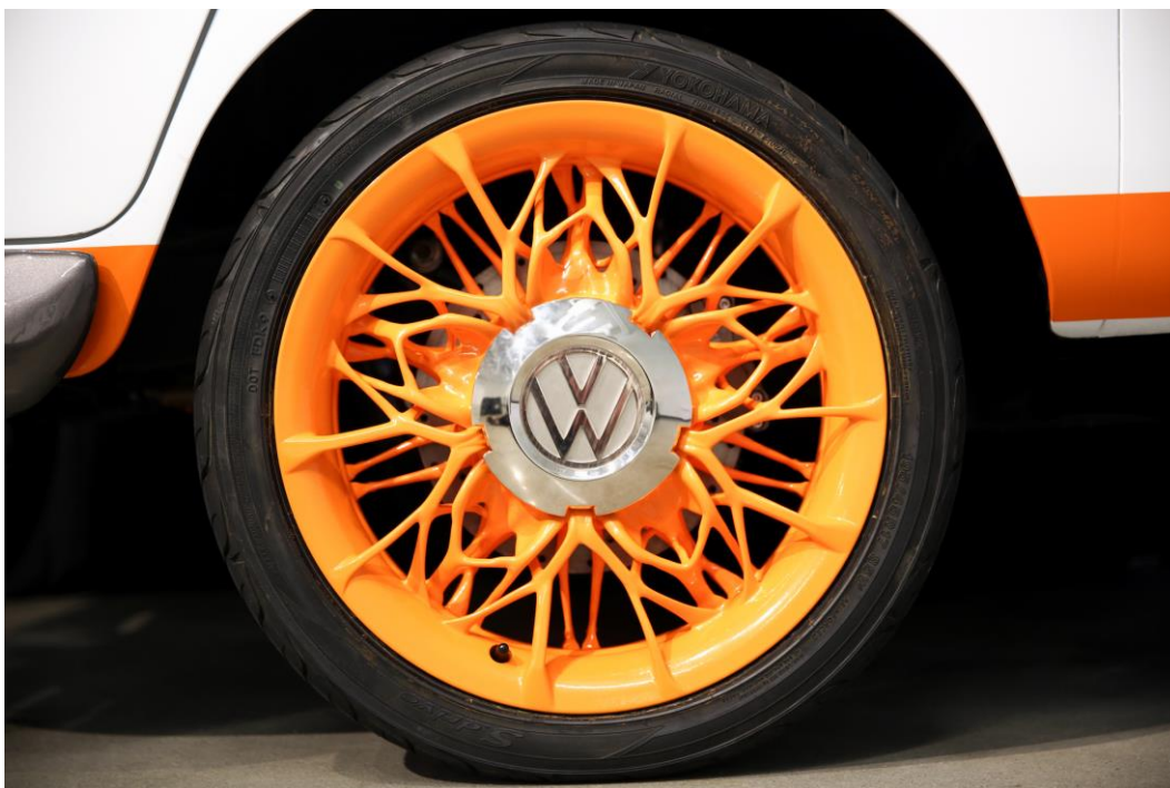
Obr. 3.11 Disk kola navržený metodou generativního designu [8]
