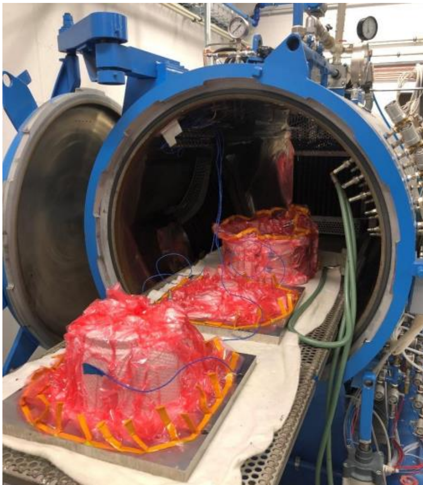
Obr. 3.24 Dokončené ráfky kol připravené k vytvrzovacímu procesu v autoklávu [18]
