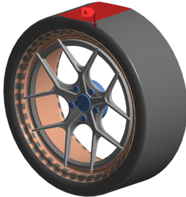
Obr. 4.13 Simulační model s okrajovými podmínkami situace stojícího vozidla
