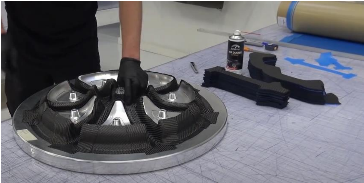
Obr. 3.23 Proces kladení prepregových přířezů do formy tvořící celokompozitní disk kola automobilu [17]
