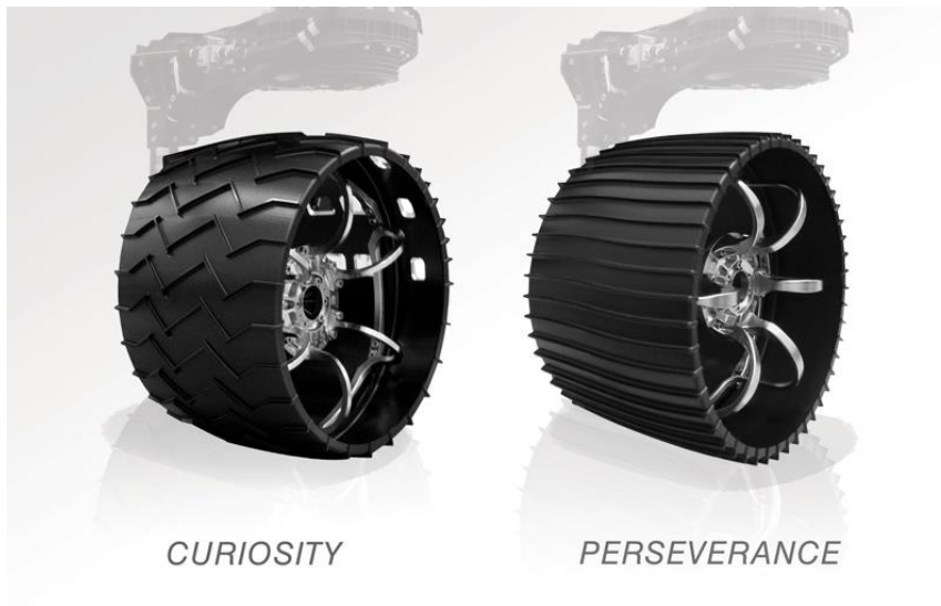
Obrázek 8: Rozdíl kol Curiosity a Perseverance [16]
