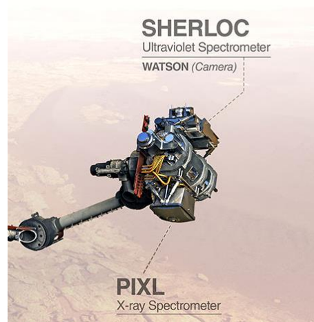
Obrázek 11: Popis věže robotického ramene [26]
