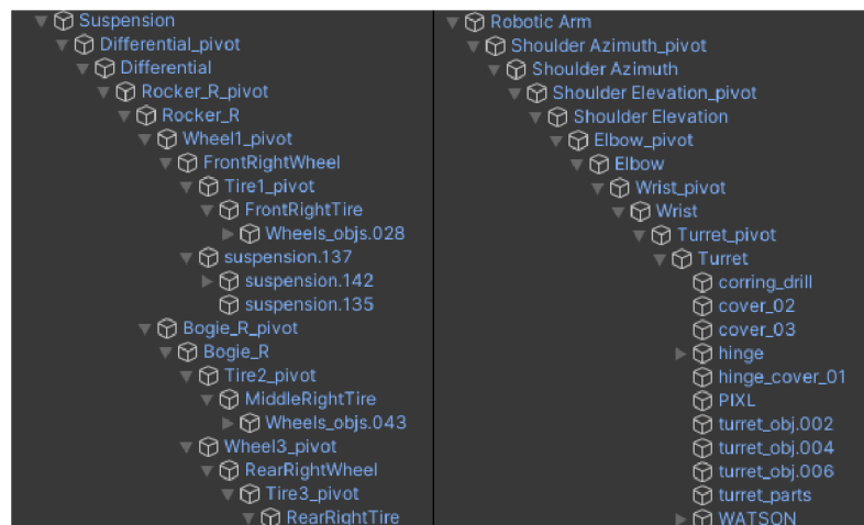
Obrázek 17: Příklad hierarchie komponent podvozku a robotického ramene
