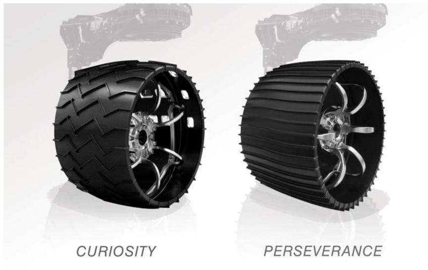
Obrázek 8: Rozdíl kol Curiosity a Perseverance [16]
