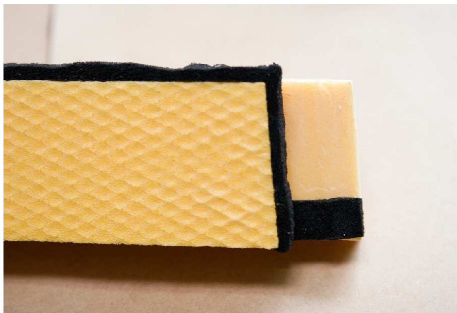
Obr. 24 přechod komprimační pásky přes roh (7)
