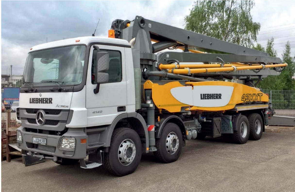
Obr.8.4 Autočerpadlo LIEBHERR 43 R4 XXT
