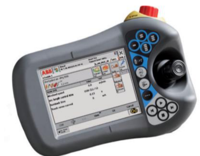
Obrázek 3. Schéma Offline programování (1) Obrázek 4. Teach pendant ABB IRC5 (2)
