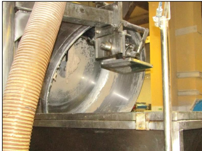
Obrázek 5 Překlopení těsta z díže do násypného koše (autor)
