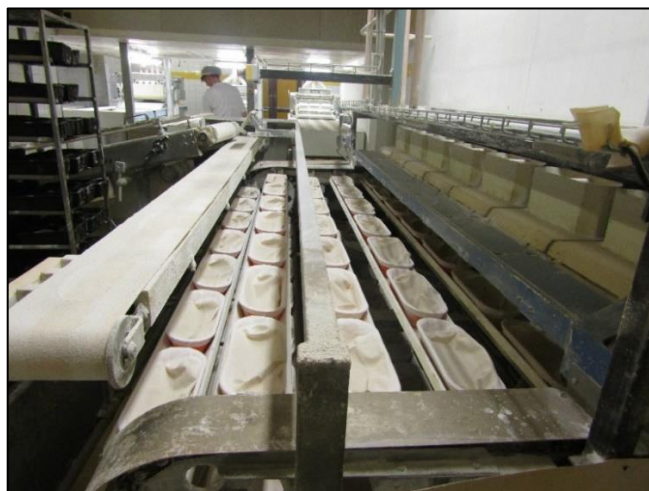
Obrázek 10 Přesun klonků z vyvalovače do laviček kynárny (autor)
