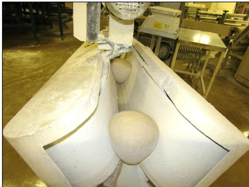
Obrázek 9 Klonky při zpracování na vykulovači (autor)
