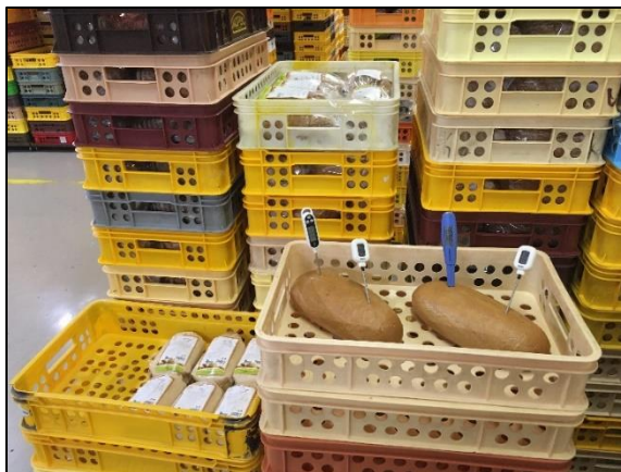
Obrázek 14 Měření teploty chlebů v hloubce 1 cm a ve středu (autor)
