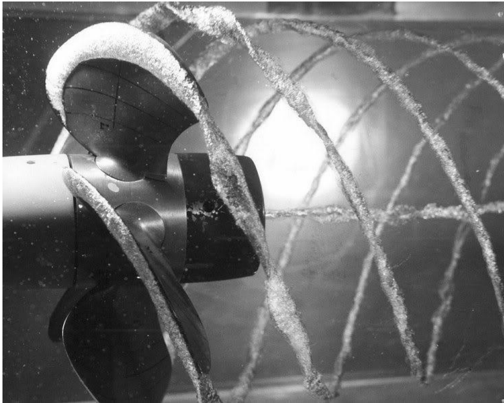
Obr. 6 Lodní šroub a proud plynu Zdroj: http://watercraftjournal.com
