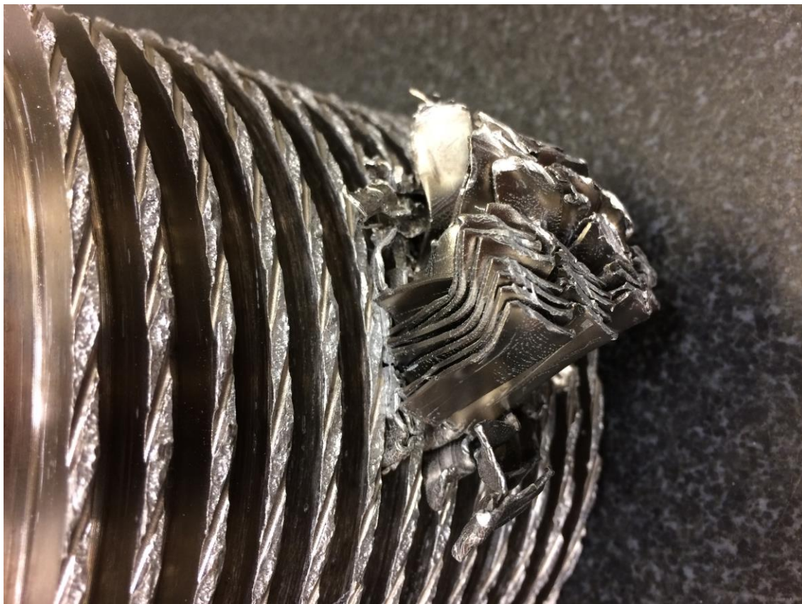
Obr. 28 příčina selhání vývěvy – statorové plechy
