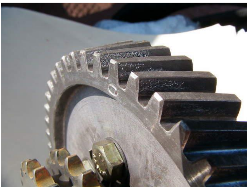
Obr. 11 Pitting na zubech ozubeného kola
