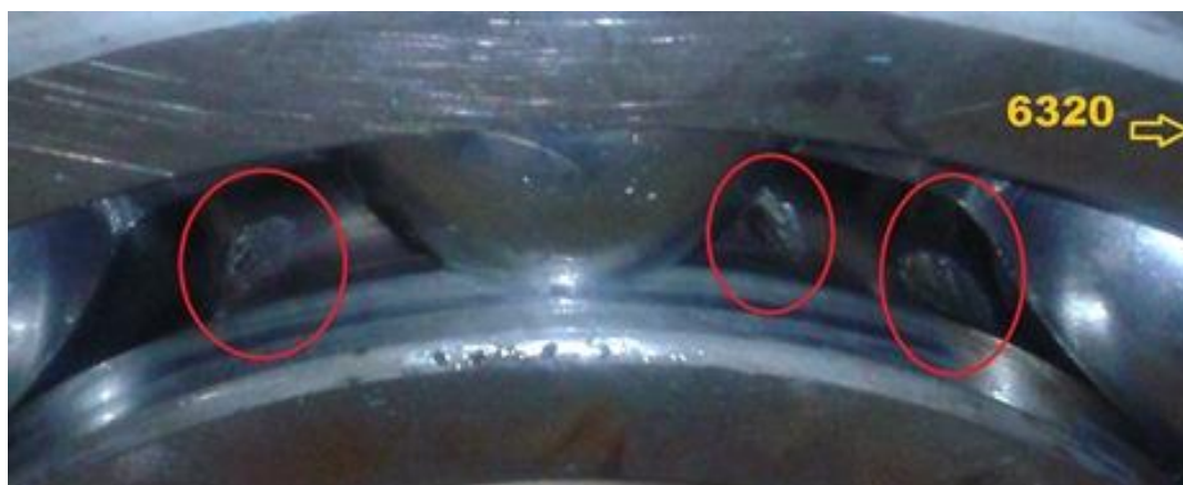
Obr. 8 Vibrační opotřebení ložiska
