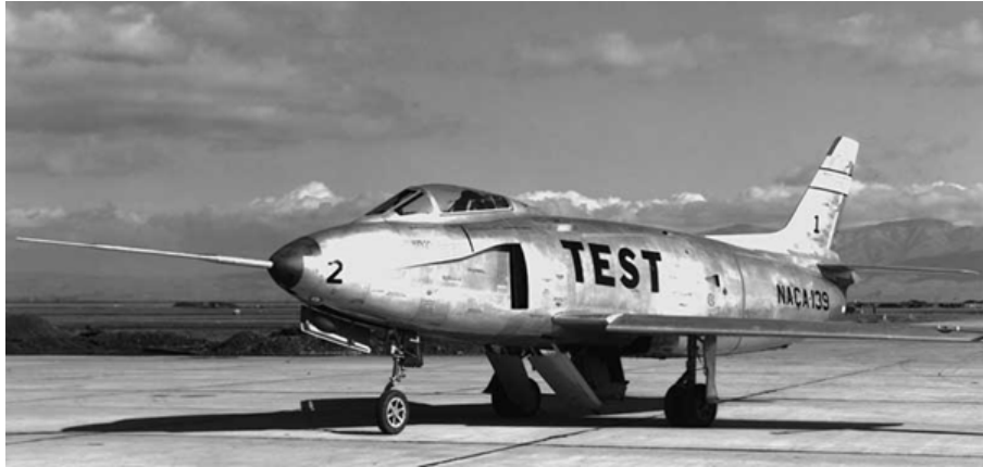
Obr. 5.7: Využitie NACA vstupu na lietadle YF-93A [20]
