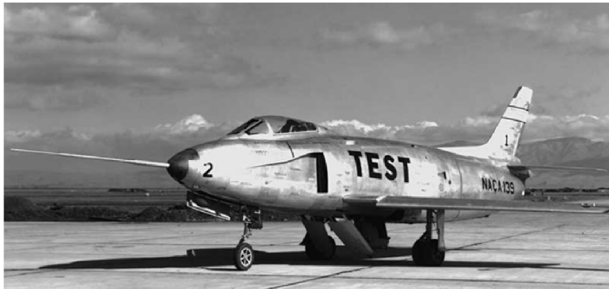
Obr. 5.7: Využitie NACA vstupu na lietadle YF-93A [20]
