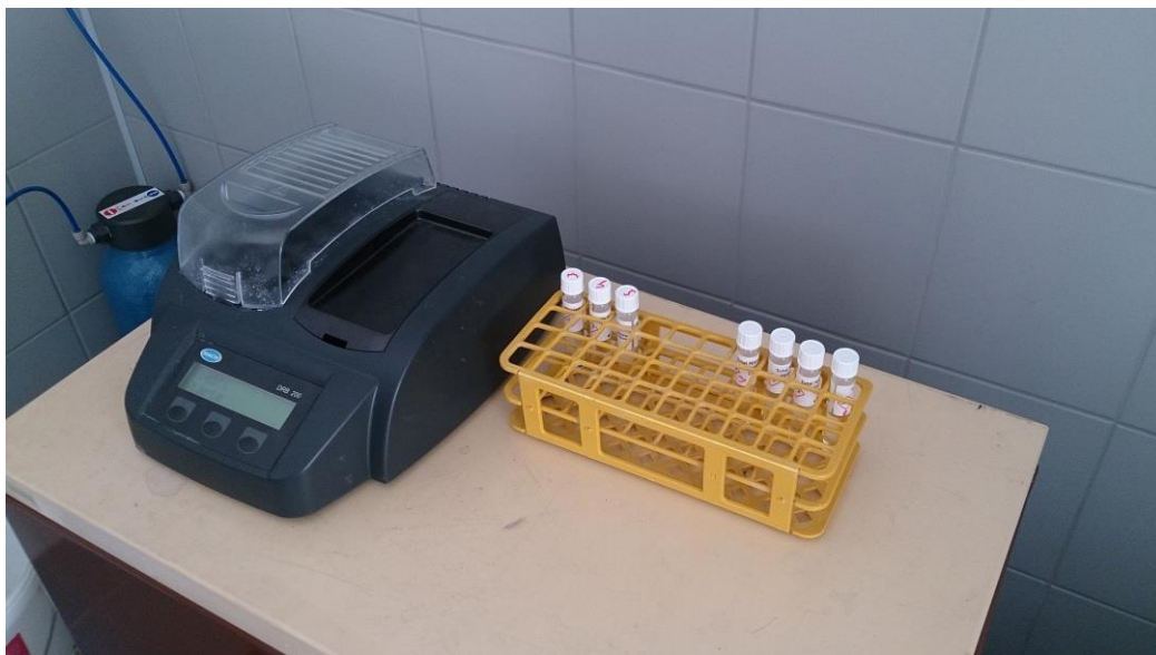
Příloha č. 13: Termoreaktor HACH DRB 200 a připravené vialky pro měření celkového fosforu – archiv autora
