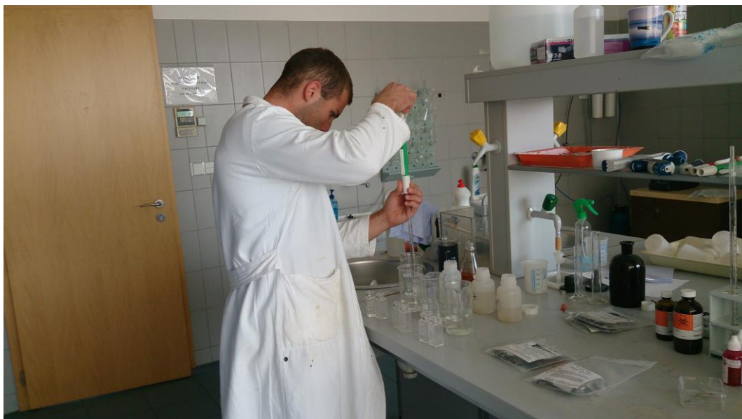
Příloha č. 15: Odebírání přefiltrovaného vzorku pro měření fosforečnanů ve spektrofotometru – archiv autora
