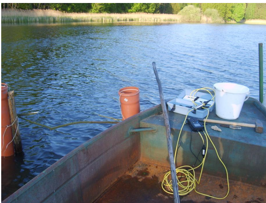
Obrázek 24 Rybník Lipičí: měřicí přístroj HACH-Lange HQ40D
