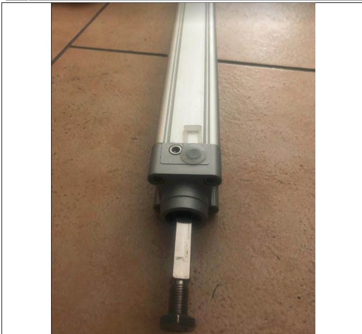
Obr. č. 8 Pneumatický válec Festo s čtvercovou pístnicí označení Q
