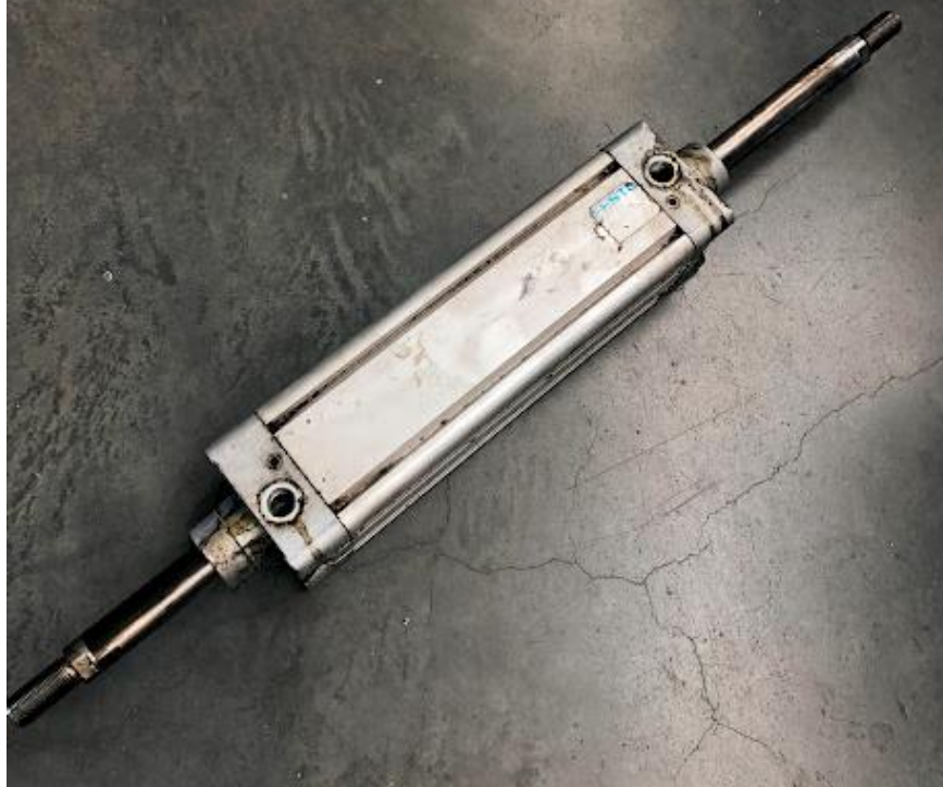
Obr. č. 9 Pneumatický válec Festo s průběžnou pístnicí
