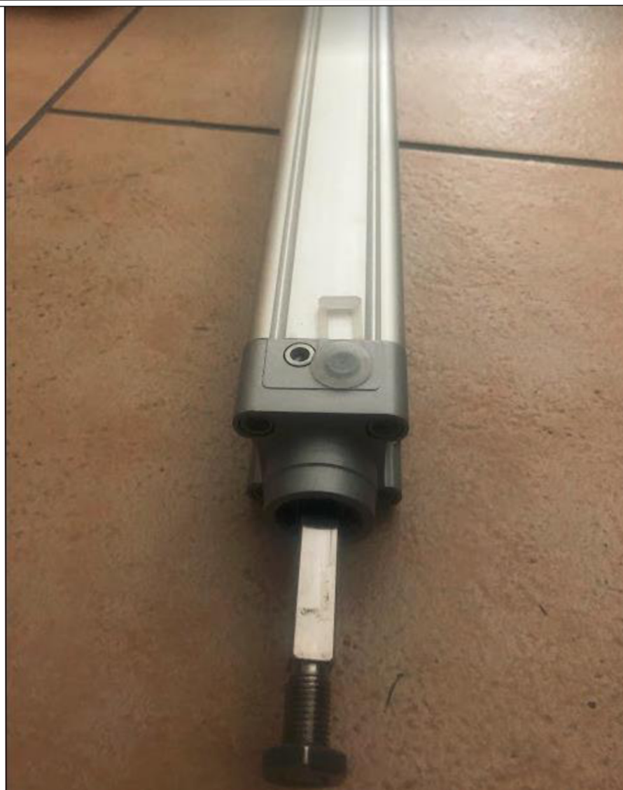
Obr. č. 8 Pneumatický válec Festo s čtvercovou pístnicí označení Q
