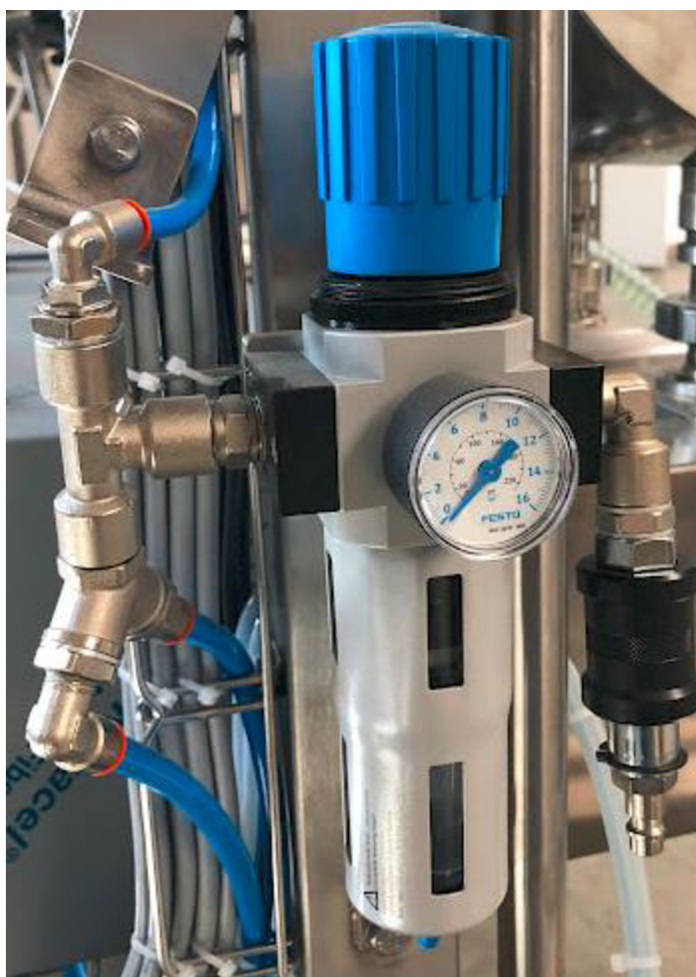
Obr. č. 19 Redukční ventil 3/8 s manometrem značky Festo
