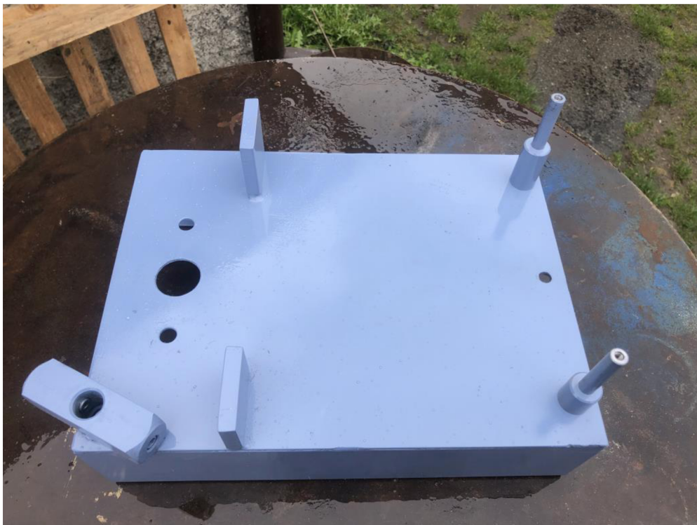
Obr. č. 24 Nosný rám po finálním laku
