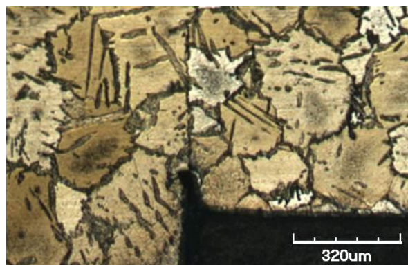
Obr. 77 Detail neprůvaru kořene svaru vzorku PF3
