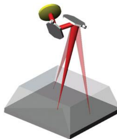
Obr. 13 Vychylování laserového paprsku [25]
