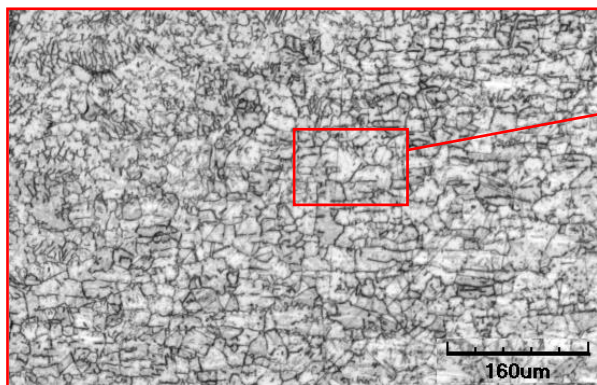
Obr. 67 Detail struktury svarového kovu vzorku PA3
