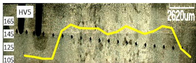
Obr. 91 Mikrotvrdot vzorku PF3
