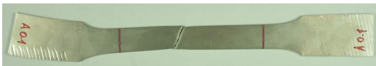
Obr. 96 Vzorek s místem porušení mimo zkoumanou oblast
