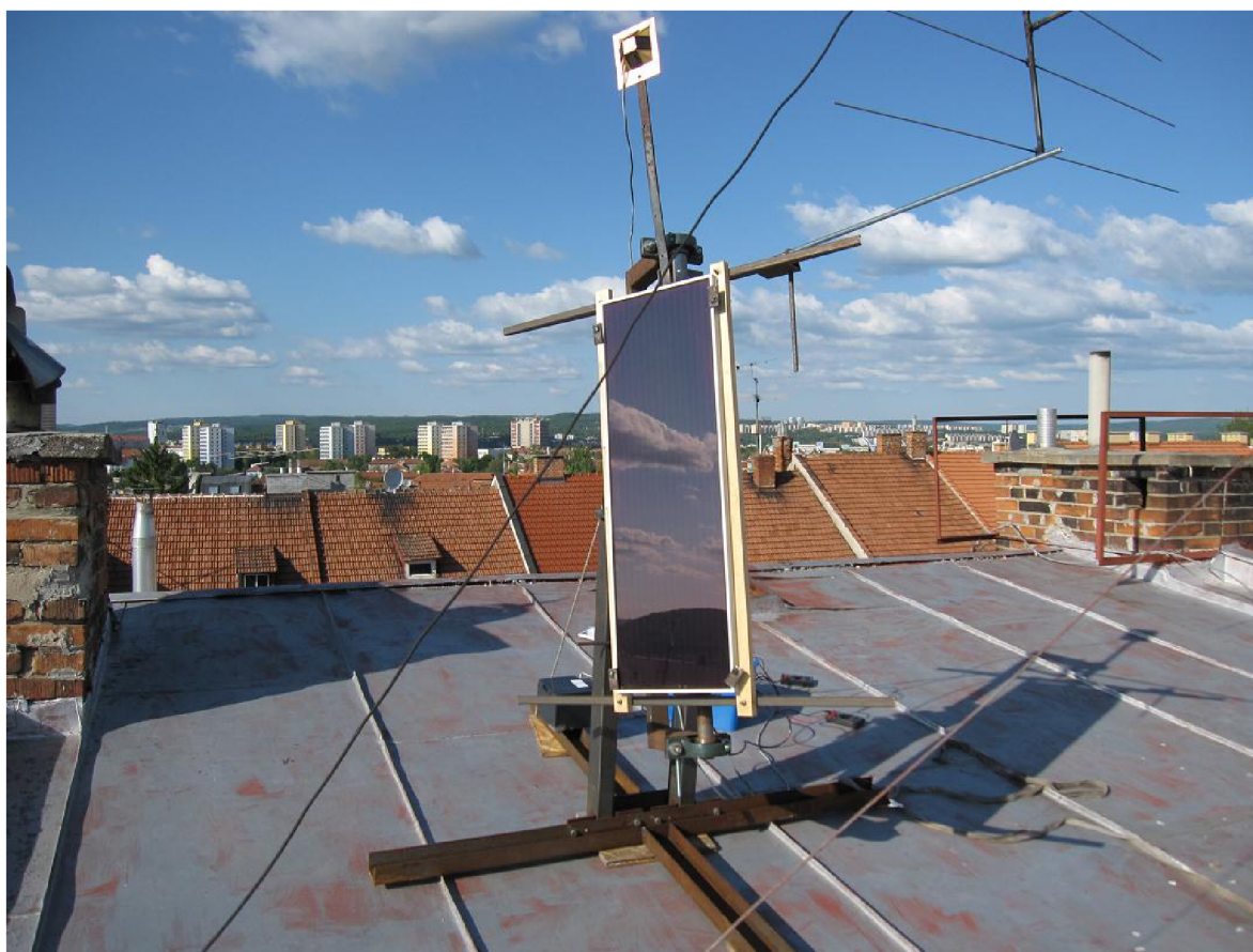
Příloha 2: Konstrukce pro polohování solárního panelu v krajní poloze obou os
