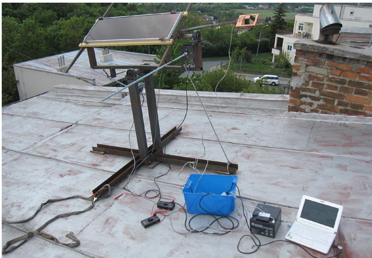
Příloha 2: Konstrukce pro polohování solárního panelu v krajní poloze obou os
