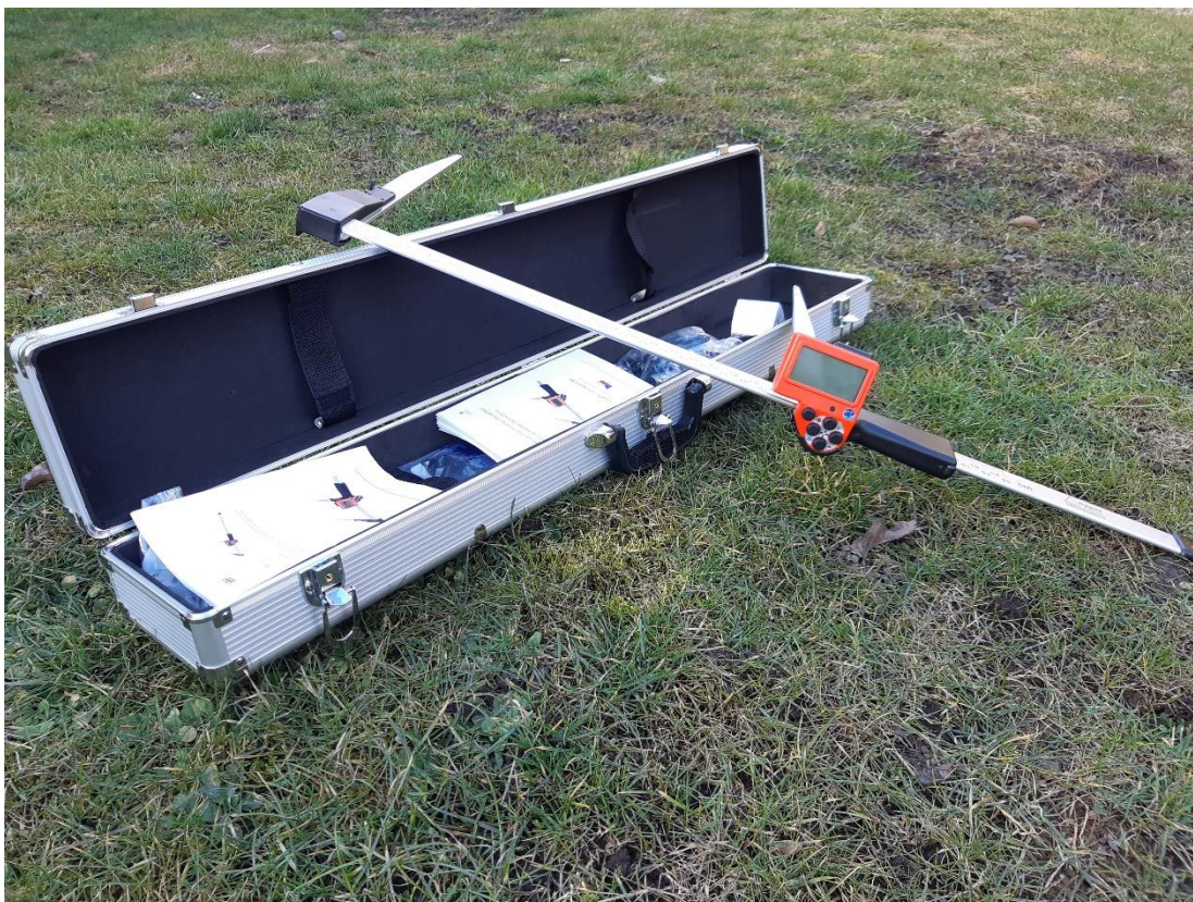
Příloha 7. Digitální průměrka Mantax Digitech II a měření v terénu.
