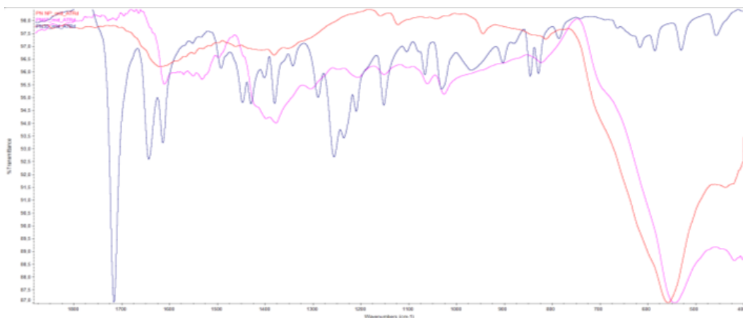
Obr. 19: Infračervená spektra maghemitových nanočástic (červeně), komplexu 5 (modře) a komplexu [\text{Ir}(\eta^5\text{-Cp}^*)\text{Cl}_2(4\text{-ppa})] navázaného na povrch nanočástic (NP- 5 ) (růžově)
