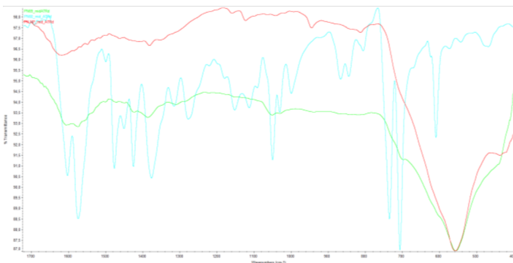
Obr. 18: Infračervená spektra maghemitových nanočástic (červeně), komplexu 4 (modře) a komplexu [\text{Ru}(\eta^6\text{-pcym})(\text{en})(3\text{-ppa}^-)]\text{BPh}_4 navázaného na povrch nanočástic (NP-4) (zeleně)
