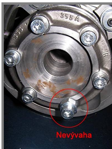
Obr. IVa Nevývaha náhradní hmoty
