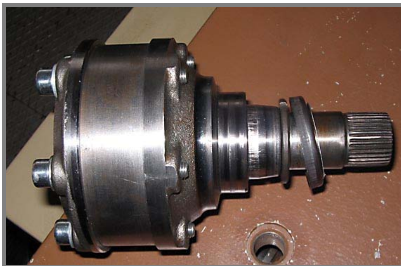
Obr. 19 Unašeč s náhradní hmotou
