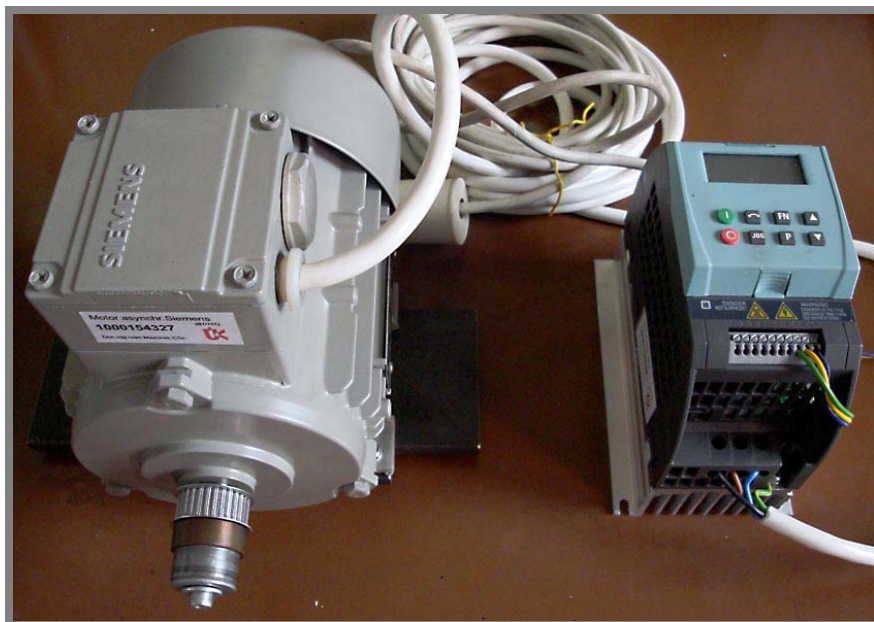
Obr. 24 Pohon stanice – elektromotor s frekvenčním měničem
