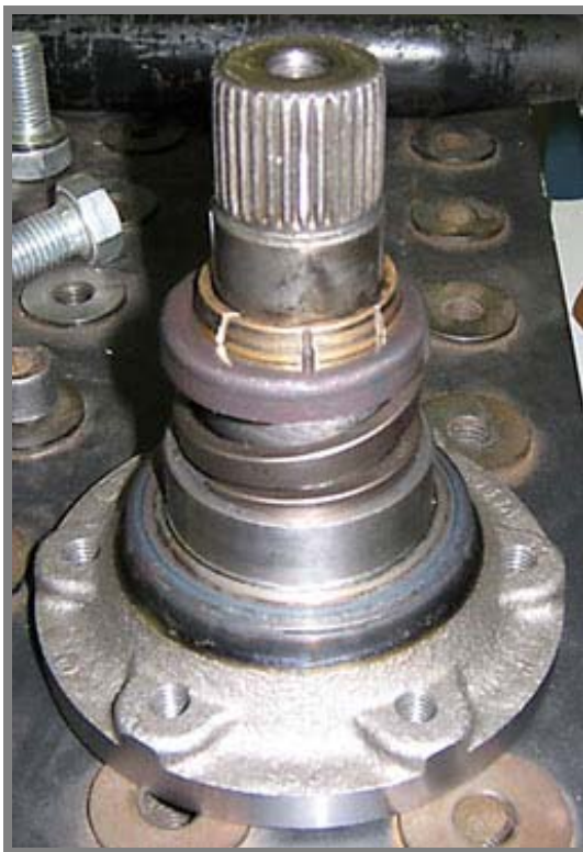
Obr. 32 Sériový unašeč s antiwummern – přítlačná pružina, třecí kroužek
