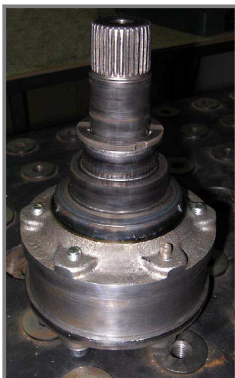
Obr. 34 Sériový unašeč bez pružné vazby (antiwummern)
