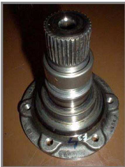
Obr. VIIa Unašeč diferenciálu s nalisovaným polygonálním ložiskem
