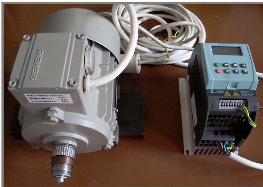
Obr. 24 Pohon stanice – elektromotor s frekvenčním měničem
