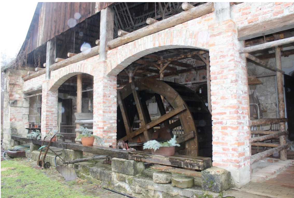
Nové mlýnské kol, na zídce možno vidět dva mlýnské kameny (foto: Marie Legnerová 16. 3. 2019)
