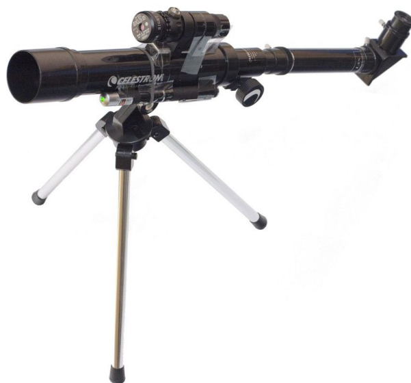
Obr. 6.7: Hvězdářský teleskop Celestron PowerSeeker 40TTAZ s připevněným laserovým zaměřovačem a pomocným laserovým ukazovátkem.
