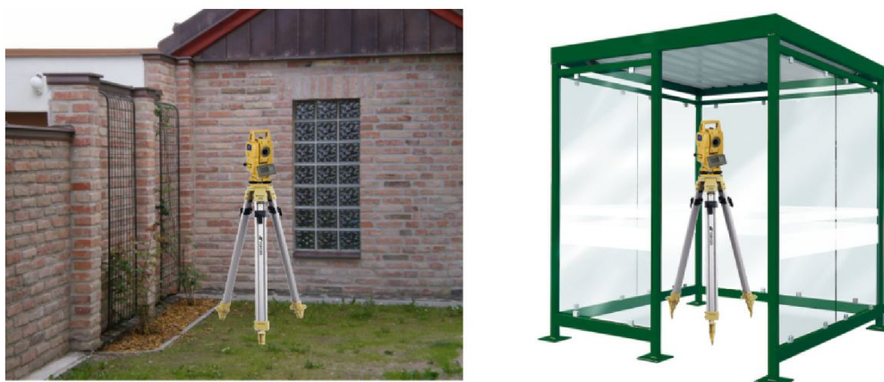
Obr. 6.4: Zabezpečení přístroje před silným větrem umístěním v rohu zástavby (vlevo) a krytem (vpravo).
